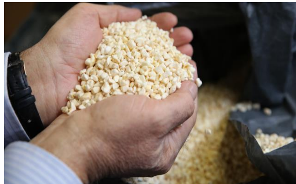
Nachwachsender Rohstoff: Popcorngranulat aus geschrotetem Industriemais eignet sich für die Herstellung leichter Verbundwerkstoffe.
